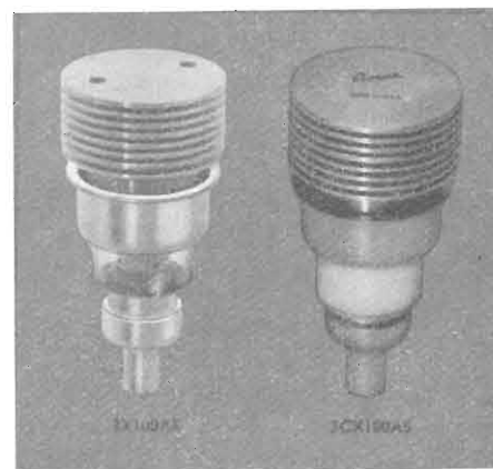
Fig. 5 - Triodi ad elettrodi piani in versione normale vetro-metallo (a sinistra) e in versione ceramica-metallo.
