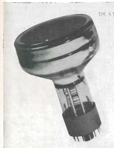
Fototubo moltiplicatore tipo 6394. Anche questo tipo ha dieci stadi e presenta una sensibilità media di 60 \mu\text{A/lumen} .
