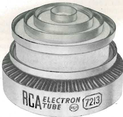
Fig. 7 - Tetrodo a fascio 7213 della RCA, raffreddato ad aria forzata.
