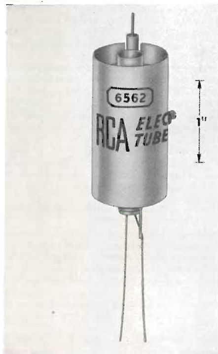
Fig. 4 - Triodo a matita in cavità coassiale fissa per uso su radiosonde. È il tipo 6562 della RCA.
